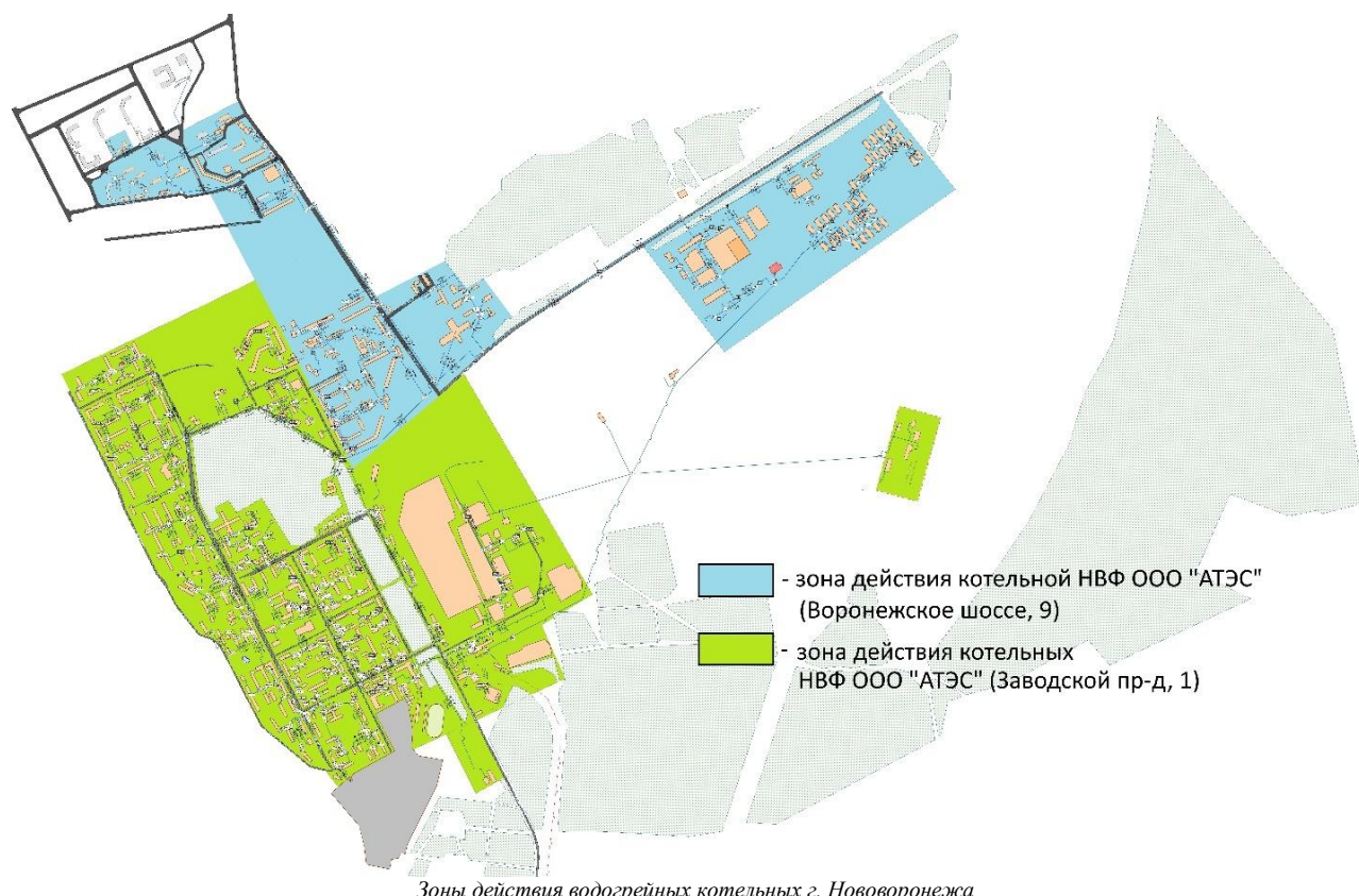
Зоны действия водогрейных котельных г. Нововоронежа
