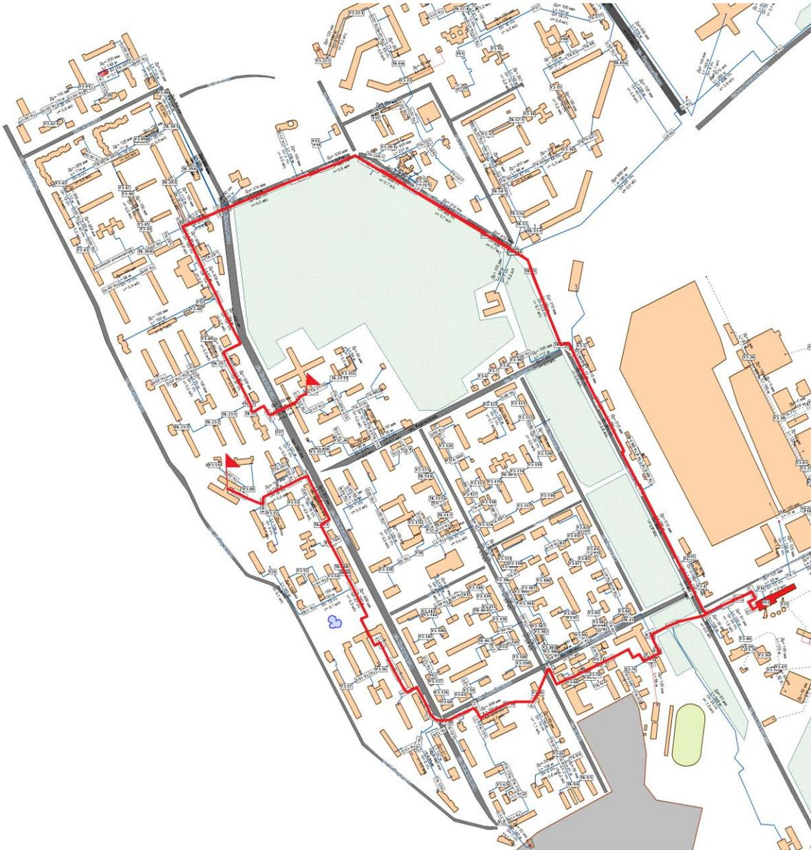
Рис. 11.3.1.1. Расчетные участки от котельной №3 до наиболее удаленных потребителей.
