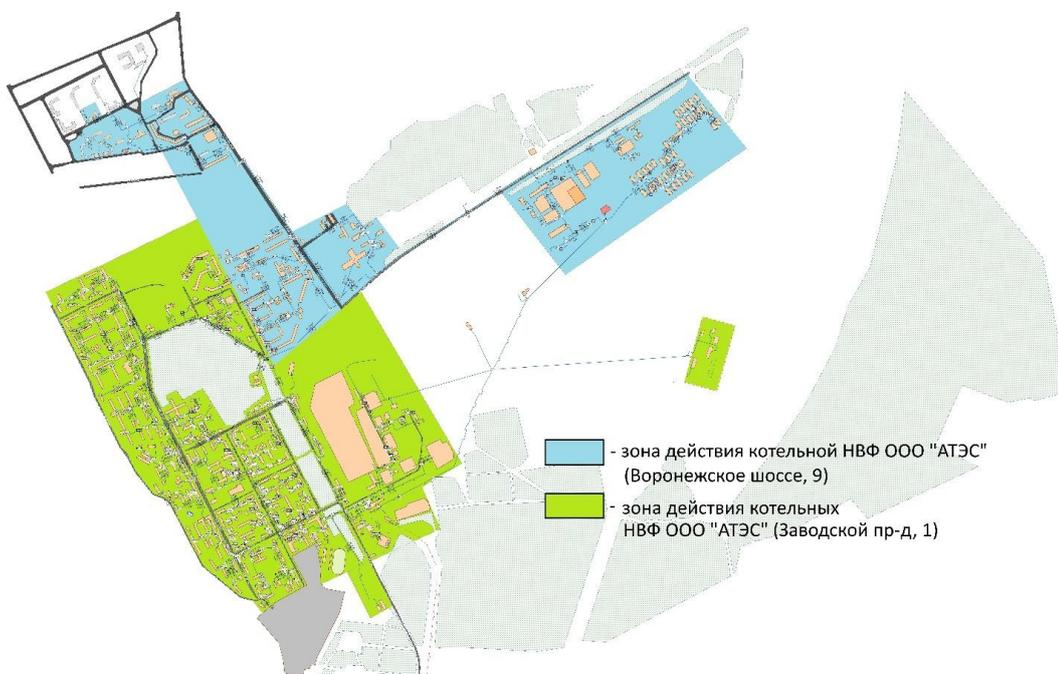
Рисунок 2.1.2. Зоны действия водогрейных котельных г. Нововоронежа
