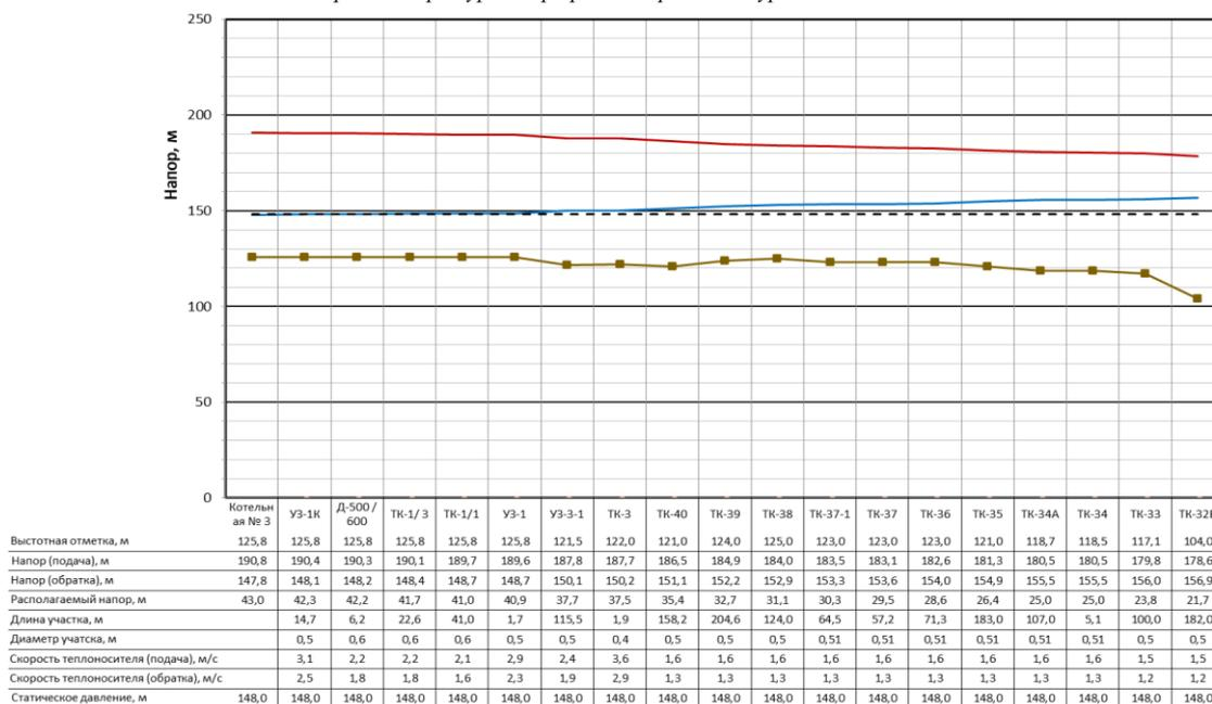
Рис. 1.3.7.5. Пьезометрический график тепловой сети от котельной № 3 (Заводской пр-д, 1) до Медсанчасти 33 (ул. Космонавтов, 18) при температурном графике со срезкой на уровне 110 °С.
