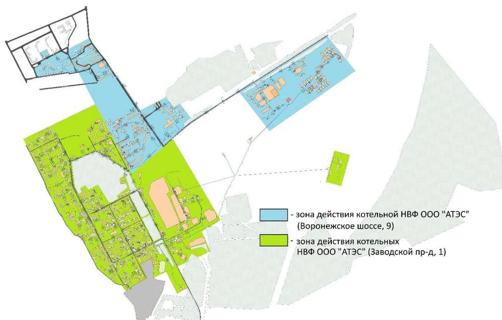
Рисунок 1.1.3.1. Зоны действия водогрейных котельных г. Новovoroneжа
