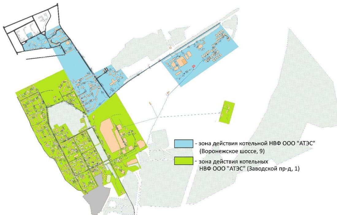
Рисунок 1.4.1. Зоны действия водогрейных котельных г. Нововоронежа
