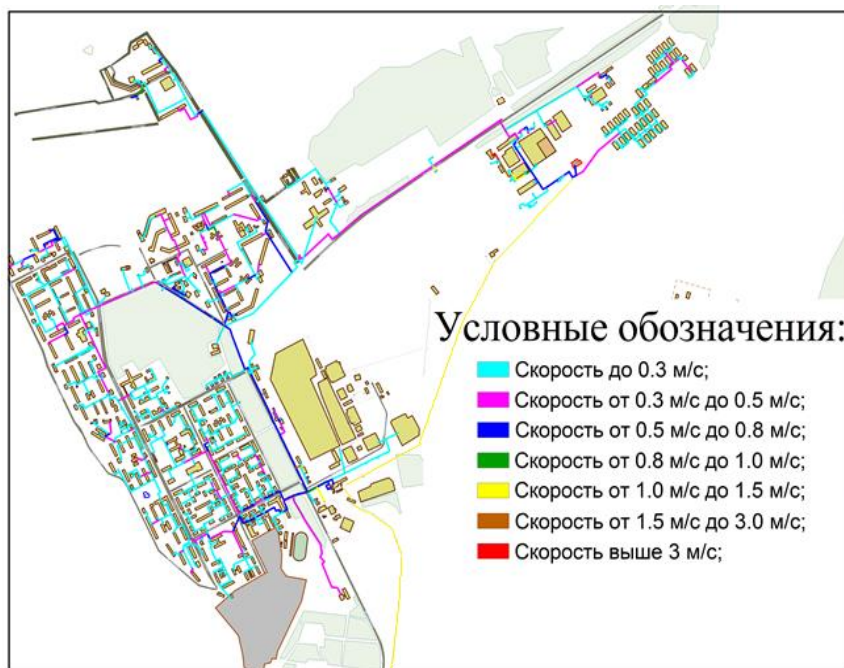
Рисунок 5.6.1. Распределение тепловых сетей по скорости движения теплоносителя в трубопроводах
