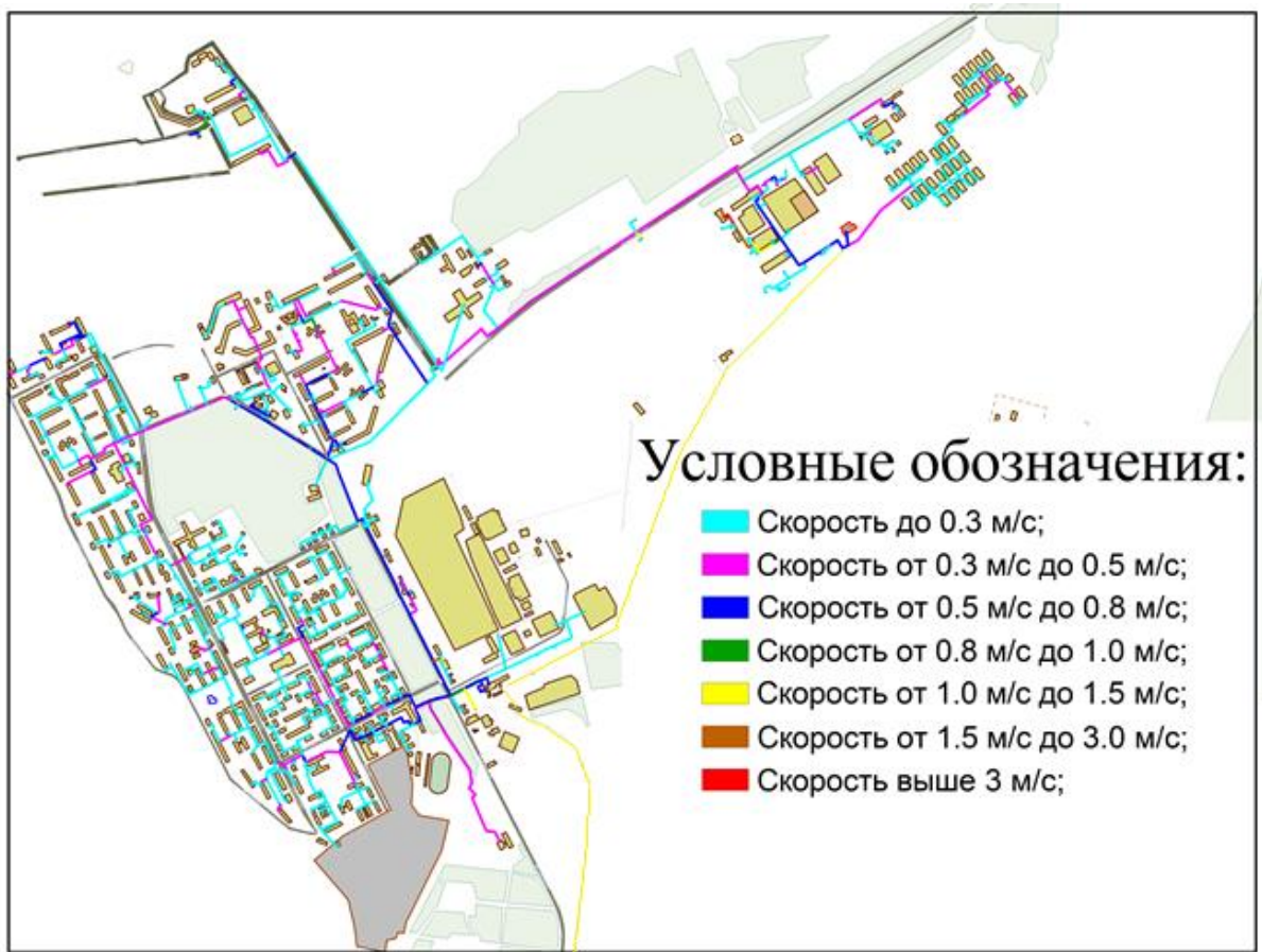
Рисунок 5.6.1. Распределение тепловых сетей по скорости движения теплоносителя в трубопроводах.
